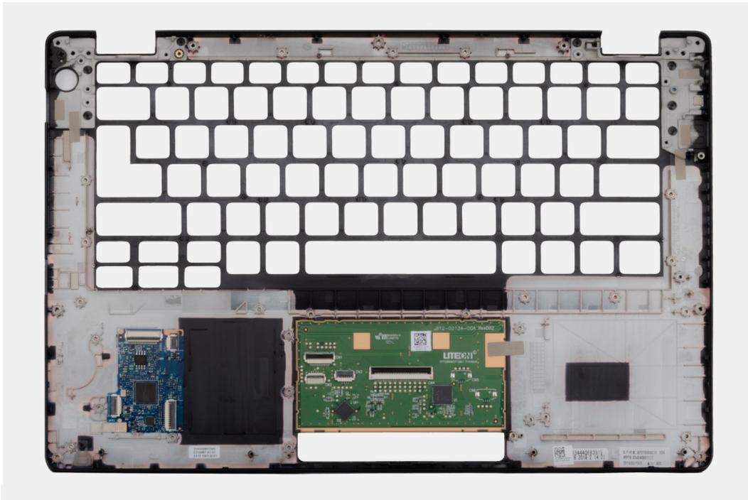
Apoio para as mãos com leitor de smart card sem contato:
